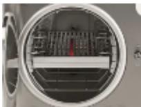
Sistema de alojamiento modular para cargar el autoclave. Equipado con 3 pares de soportes para colocar las bandejas, permite aprovechar todo el diámetro de la cámara y colocar incluso aquellas cargas más voluminosas, como las cajas de cirugía.
