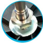
Optimización de la conexión del eje del motor mediante una tuerca de alta precisión. Esto reduce los desequilibrios de la turbina.
