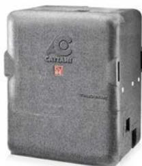
Aspiración progresiva, de 1 a 3 equipos en su versión A. Motor mejorado, más eficiente y potente, para la mejor aspiración del mercado con el consumo más bajo. Potencia rendida: 1.1 kW - 4.8 A. Caudal máximo: 1400 l/min (1700 l/min con password). Presión máxima en servicio continuo: 210 mbar.
