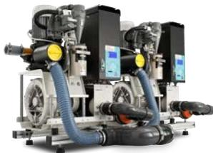
Potencia total: 3kW - 13A. Caudal máximo de aspiración: 2.800 l/min. Presión de trabajo: 210 mbar. En un sistema de aspiración Smart en paralelo, las máquinas trabajan juntas para todos los sillones, reconociéndose y regulando la velocidad según la carga de trabajo, si una falla la otra sigue.
