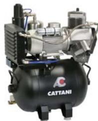
Compresor para fresadoras CAD CAM, de 3 cilindros con secador de aire. Línea especial de compresores Cattani, que trabajan a presiones más altas respecto a los compresores convencionales. Dispone de un motor monofásico 230V 50 Hz y potencia de 1,5 kW - 10.2 A.
