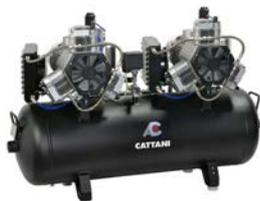
Compresor para fresadoras CAD CAM, con 2 cabezas de 3 cilindros con dos secadores de aire. Línea especial de compresores Cattani, que trabajan a presiones más altas respecto a los compresores convencionales. Dispone de 2 motores monofásicos de 230V 50 Hz y potencia total de 1,5 kW - 20.4 A.
