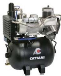
Compresor para fresadoras CAD CAM, de 3 cilindros con secador de aire. Línea especial de compresores Cattani, que trabajan a presiones más altas respecto a los compresores convencionales. Dispone de un motor trifásico 400V 50 Hz y potencia de 1,5 kW - 3,7 A.
