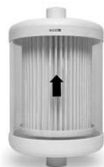
Filtro especial instalado en la salida de aire expulsado por la máquina de aspiración. Compuesto por un filtro HEPA H14 con carbones activos y un tratamiento químico antibacteriano, protegido herméticamente a su vez por una estructura resistente a la alta temperatura y humedad.
