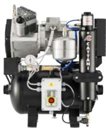
Compresor de 2 cilindros con secador de aire, para 2/3 equipos. Dispone de las siguientes características: Motor monofásico de 230V 50 Hz, potencia 1,2 kW - 7.7 A, depósito de aire con una capacidad de 30l, caudal efectivo a 5 bar de 160 l/min y un nivel sonoro de 71.8 dB (A).
