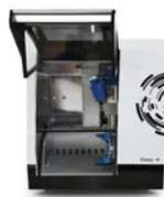
Máquina de alta precisión, que destaca por el uso de 4 ejes de trabajo simultáneos que consiguen unos resultados óptimos, incluso en aleaciones no preciosas extremadamente duras sobre una base de cobalto-cromo.
