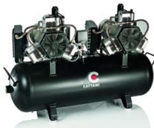
Compresor tándem 3 cilindros con dos secadores de aire, para 10 equipos. Dispone de las siguientes características: 2 motores monofásicos 230 50Hz independientes, potencia total de 3 kW - 20.4 A, un depósito de aire de 150 litros, caudal efectivo a 5 bar de 476 l/min y su nivel sonoro es de 77 dB (A).
