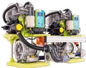
Potencia total: 2.24kW - 16A. Caudal máximo de aspiración: 1.800 l/min. Presión de trabajo: 210 mbar. Incluye dos válvulas unidireccionales (1191282). Las máquinas trabajan juntas para todos los sillones, reconociéndose y regulando la velocidad según la carga de trabajo, si una falla la otra sigue.
