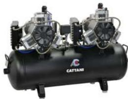
Compresor para fresadoras CAD CAM, con 2 cabezas de 3 cilindros con dos secadores de aire. Línea especial de compresores Cattani, que trabajan a presiones más altas respecto a los compresores convencionales. Dispone de 2 motores trifásicos de 400V 50 Hz y potencia total de 1,5 kW - 7.4 A.
