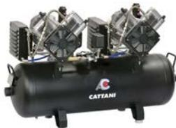
Compresor para fresadoras CAD CAM, con 2 cabezas de 2 cilindros con dos secadores de aire. Línea especial de compresores Cattani, que trabajan a presiones más altas respecto a los compresores convencionales. Dispone de 2 motores trifásicos 50 Hz y potencia total de 3 kW – 7,2 A.
