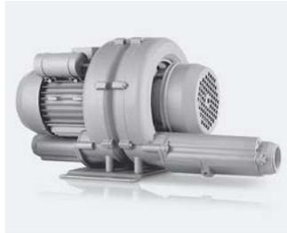
Motor de anillos seco para 1 equipo, con doble ventola, para conseguir un nivel de vacío superior a los motores convencionales. Potencia: 0,7KW - 5,3A. Caudal máximo:1.330 l/min. Presión de trabajo: 270 mbar. Nivel sonoro: 64 dB(A).
