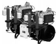
Compresor de 2 cabezas de 6 cilindros con cuatro secadores de aire, para 20 equipos. Dispone de las siguientes características: 2 motores trifásicos de 400V 50Hz independientes, una potencia total de 6.5 kW - 15 A, depósito de aire de 300 litros, un caudal efectivo a 5 bar de 952 l/min y un nivel sonoro de 81 dB (A).
