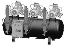
Compresor con 3 cabezas de 3 cilindros con tres secadores de aire, para 15 equipos. Dispone de las siguientes características: 3 motores trifásicos 400V 50Hz independientes, potencia total de 4.5 kW - 11.1 A, un depósito de aire de 300 litros, caudal efectivo a 5 bar de 714 l/min y su nivel sonoro es de 75 dB (A).
