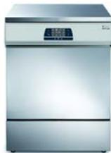
Desinfección térmica, descontaminación y lavado a presión del instrumental dental. Lava y desinfecta todo tipo de materiales. Conforme normativa EN-15883. La WD4060 incorpora secado de aire con filtro HEPA. 2 bombas dosificadoras integradas y una tercera opcional. Volumen de cámara de 150 litros.
