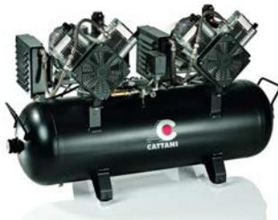
Compresor tándem de 2 cilindros con dos secadores de aire, para 6/7 equipos. Dispone de las siguientes características: 2 motores trifásicos 400V50Hz independientes, potencia total de 3 kW - 7.2 A, un depósito de aire con una capacidad de 150l, caudal efectivo a 5 bar de 320 l/min y un nivel sonoro de 73 dB (A).
