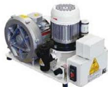
Aspiración de anillo húmedo para un equipo. El motor está protegido por una pastilla térmica. Potencia: 0.42 KW - 4A. Caudal máximo: 650 l/min. Presión de trabajo: 150 mbar. Nivel de presión sonora con aire canalizado 61 dB (A).
