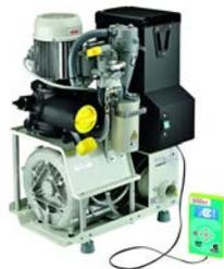
Aspiración progresiva, de 1 a 3 equipos en su versión A. Con su sistema inverter, reconoce en cada momento las necesidades de aspiración, adaptando la velocidad del motor en tiempo real. Con separador de amalgama ISO 18. Potencia rendida: 1.22 kW - 7 A. Caudal máximo: 1400 l/min (1700 l/min).
