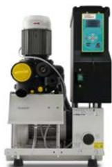
Aspiración progresiva, de 1 a 3 equipos en su versión A. Con su sistema inverter, reconoce en cada momento las necesidades de aspiración, adaptando la velocidad del motor en tiempo real. Con separador de amalgama ISO 18. Potencia rendida: 1.5 kW - 6.5 A. Caudal máximo: 1400 l/min (1800 l/min).
