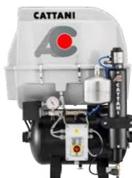
Compresor de 2 cilindros con secador de aire e insonorizado, para 2/3 equipos. Dispone de las siguientes características: Motor monofásico de 230V 50 Hz, potencia 1,2 kW - 7.7 A, depósito de aire con una capacidad de 30 l, caudal efectivo a 5 bar de 160 N l/min y un nivel sonoro de 63 dB (A).
