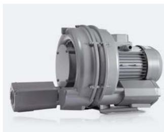
Motor de anillos seco para 2 equipos, con doble ventola, se consigue un nivel de vacío superior a los motores convencionales. Incluye válvula depresora. Alimentación monofásica: 230V 50hz. Potencia: 1.1 kW - 7.5A. Caudal máximo: 2.170 l/min. Presión de vacío: 200 mbar. Nivel sonoro: 65 dB (A).
