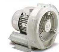
El motor está protegido con una pastilla térmica. Alimentación monofásica: 230V 50hz. Potencia: 0.4 Kw - 3,1 A. Caudal máximo: 1250 l/min. Presión de vacío: 130 mbar. Nivel sonoro: 62 dB (A).
