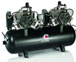
Compresor tándem 3 cilindros con dos secadores de aire, para 10 equipos. Dispone de las siguientes características: 2 motores trifásicos 400V 50Hz independientes, potencia total de 3 kW - 7.4 A, un depósito de aire de 150 litros, caudal efectivo a 5 bar de 476 l/min y su nivel sonoro es de 77 dB (A).
