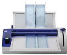
Termoselladora manual con diseño innovador para bolsas y rollos. Motor de deslizamiento en ambos sentidos. Permite definir exactamente la longitud de la bolsa sin malgastar papel. Cuenta con una base de apoyo milimetrada, su banda de sellado es de 12 mm. y su ancho máximo de sellado es de 300 mm.
