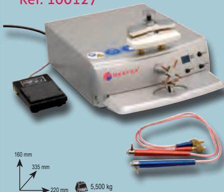
La máquina está controlada electrónicamente, lo que prácticamente elimina las chispas que normalmente se producen entre electrodos en las máquinas sin regulación. La potencia puede seleccionarse entre 30 niveles diferentes para adecuarse a los requerimientos de espesor del material que se desea soldar.
