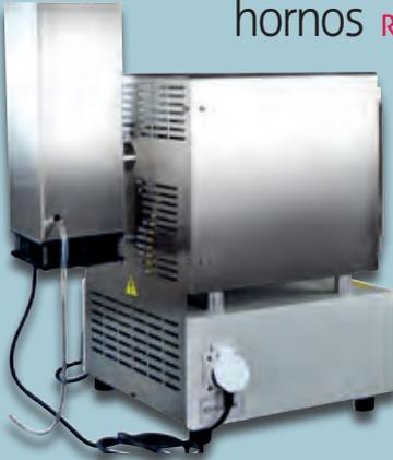
Con la instalación de éste dispositivo, se consigue un barrido suave y continuo de los gases de combustión generados en la mufla. Si se conecta al horno MESTRA HP-25, 50, 100, se obtiene un funcionamiento del extractor con desconexión programada entre 75 °C y 850 °C.
