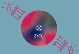
La radiación emitida por las resistencias incide en la superficie del circonio y se va transmitiendo hacia el interior:
