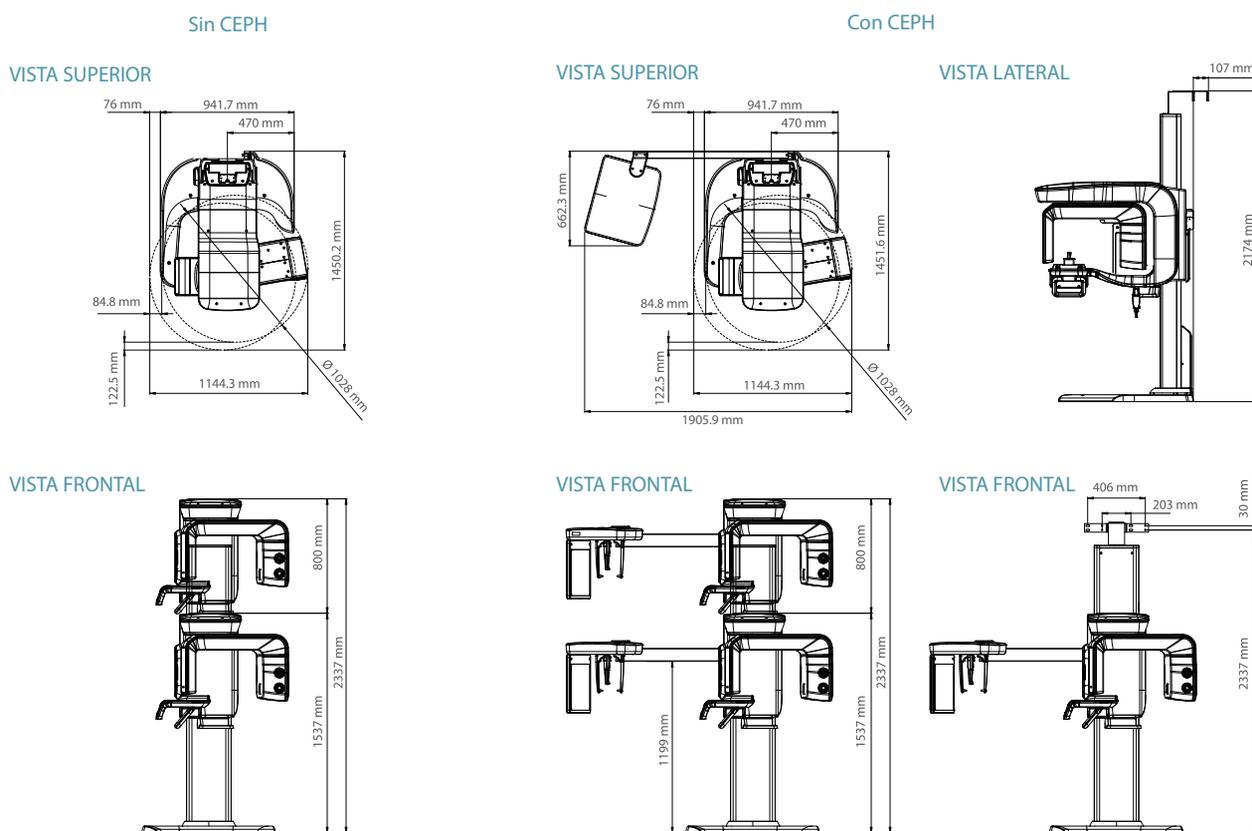
**\*Se requiere un espacio adicional de 76.2 mm detrás de la unidad para la instalación del soporte de montaje en pared.**
